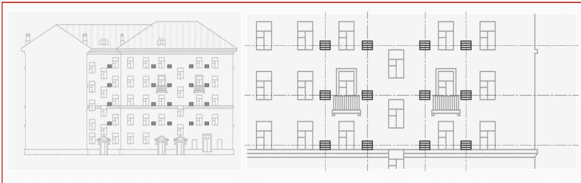
Пример правильного размещения кондиционеров на внутривором фасаде
