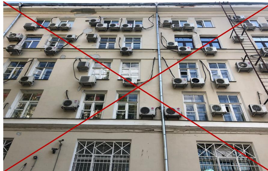
Пример НЕправильного размещения кондиционеров на внутривором фасаде
