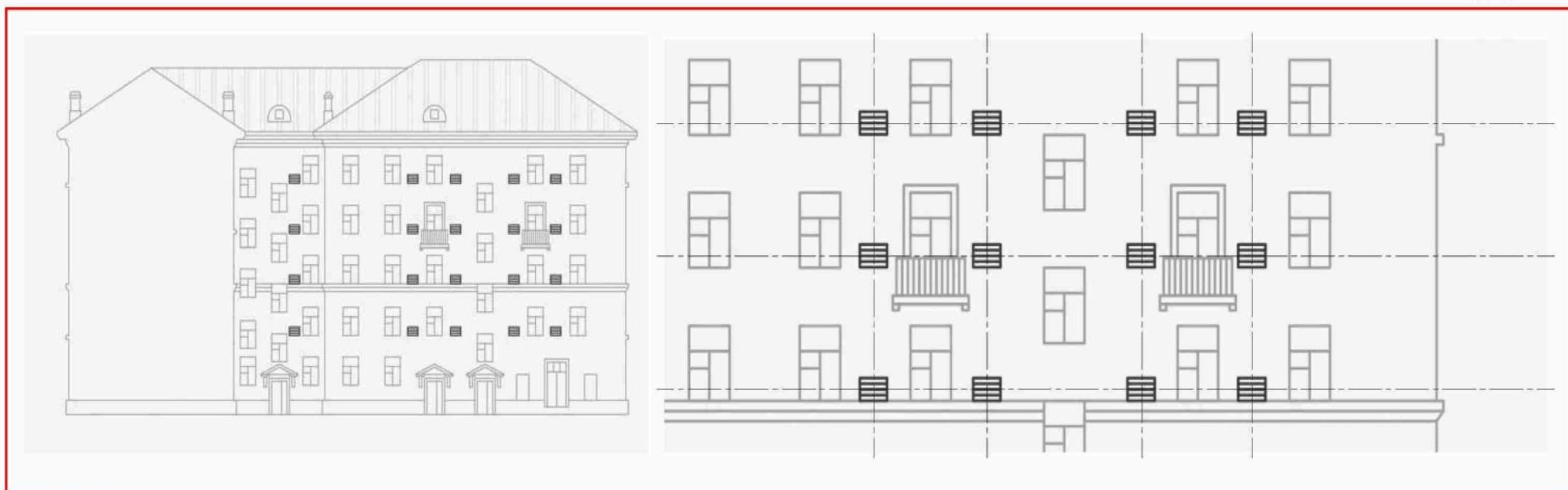
Пример правильного размещения кондиционеров на внутридвором фасаде
